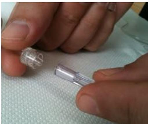
predisposte per le rilevazioni manometriche, mediante connessioni pneumatiche standard luer-lock (ISO 594).
